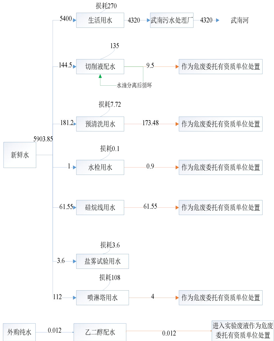
图 2-1 本项目水平衡图 单位: t/a
